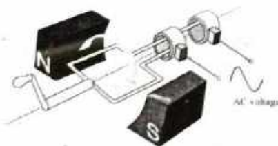
Fig.: Electrical Generator
